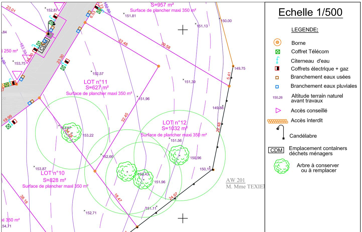
La position exacte des différents branchements sera vérifiée sur place avant la réalisation du projet de construction. L'adaptation de la construction au terrain sera étudiée en tenant compte du niveau et de la position de la voie nouvelle ainsi que des réseaux créés.
