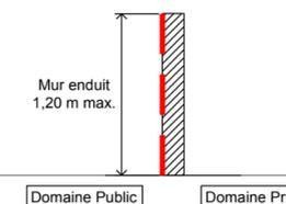
Si la limite est en bordure d'enrobé une longrine est à réaliser par l'acquéreur (rang de parpaing) au moins 2cm de vue au dessus de la voirie finie
